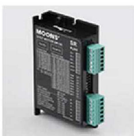
SR 系列兩相步進電機驅動器是基於 PID 電流控制演算法設計的高性價比細分型驅動器，具有優越的性能表現，高速大力矩輸出，低噪音，低振動，低發熱，特別適合 OEM 客戶的大批量應用場合。SR2 驅動器可通過撥碼開關選擇運行電流和細分，有 16 種細分，8 種電流供選擇，具有過壓，欠壓，相電流過流保護，其輸入輸出控制信號均採用光電隔離。
