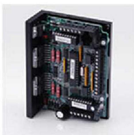
MS2035MXD 是一款雙軸步進驅動器，可同時驅動兩個電機。可工作在脈衝/方向模式和速度模式下，通過 eXposition 軟體配置；在脈衝方向模式下，可通過 PLC, MCU 等設備發送脈衝，兩路可獨立運行，細分可選；在速度模式中，包含固定速度和類比量速度模式，軟體配置，可通過機械開關控制電機的啓停/反轉；
